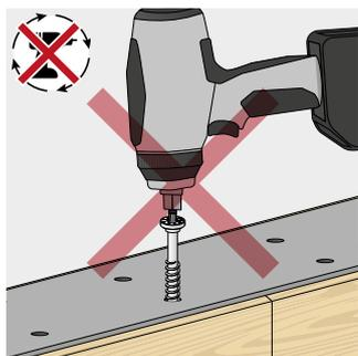
Использование импульсного/ударного шуруповерта не допускается.
